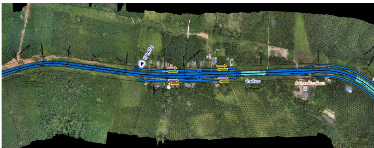
รูปที่ 7.3-4 รูปแบบการขยายทางหลวง ช่วงจาก กม.675+500 ถึง กม.676+800 บ้านฝ้ายท่า (ซ้ายทาง) และ บ้านนาพรุ (ขวาทาง) ตำบลนาคา อำเภอสุขสำราญ จังหวัดระนอง
